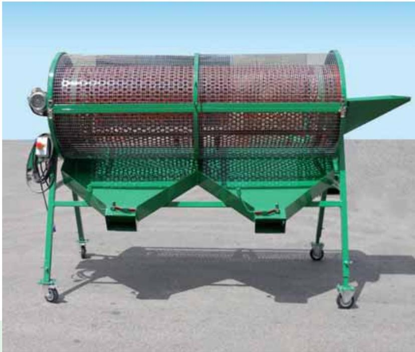
🇮🇹 La calibratrice è dotata di idonee griglie cilindriche di calibratura che selezionano il prodotto, il quale viene poi convogliato mediante tramogge in sacchi o bins. E' motorizzata in modo autonomo con energia di alimentazione elettrica. Per il carico è necessario un nastro trasportatore inclinato (non fornito e disponibile come accessorio), oppure la calibratrice può essere conglobata ad impianto post-pulizia di frutta in guscio.
