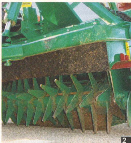
Foto 2 - Sistema anteriore pick up della macchina
